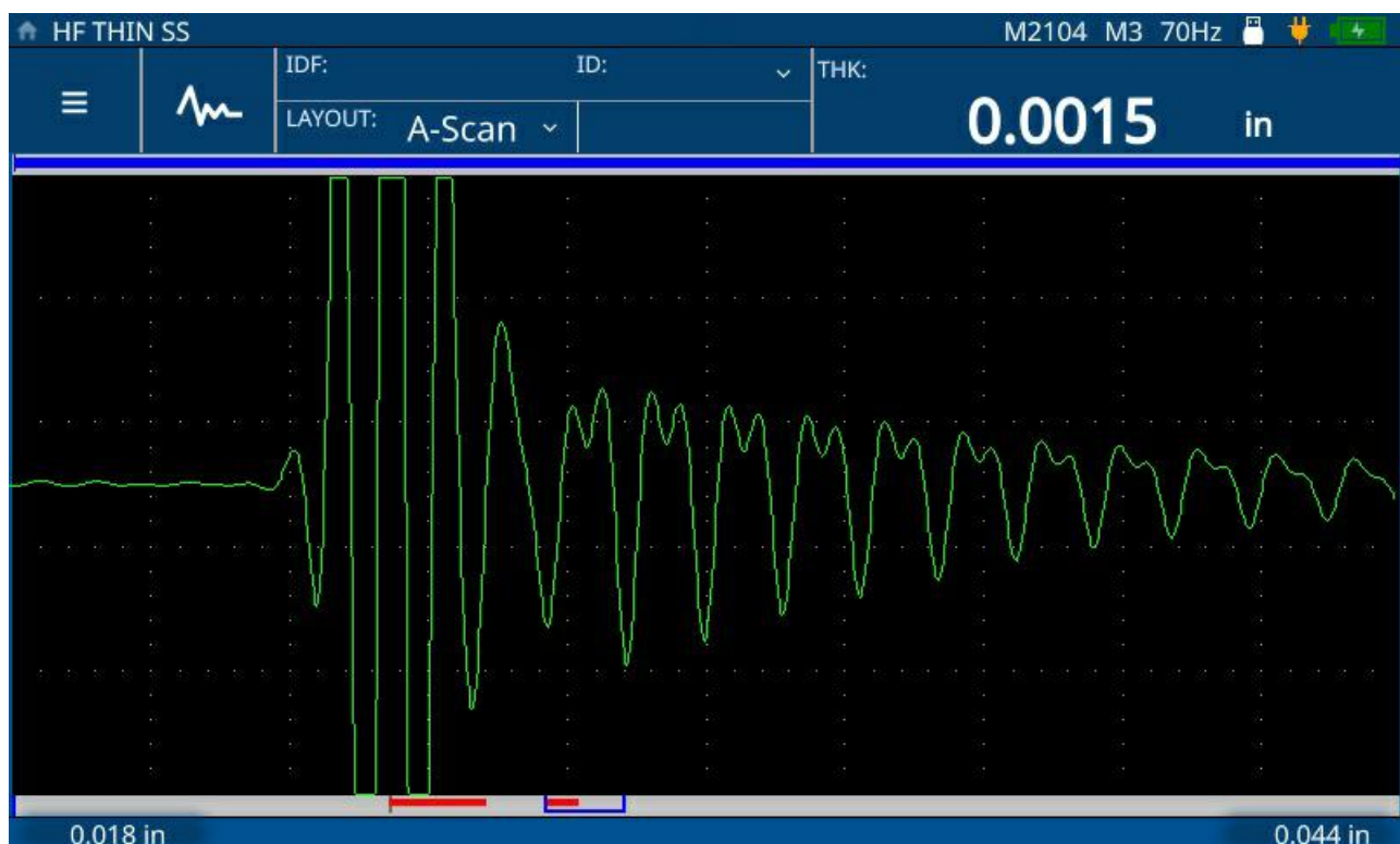
O medidor 72DL PLUS mede aço fino (0,0015 pol. ou 0,0381 mm) usando o transdutor M2104 (125 MHz)
